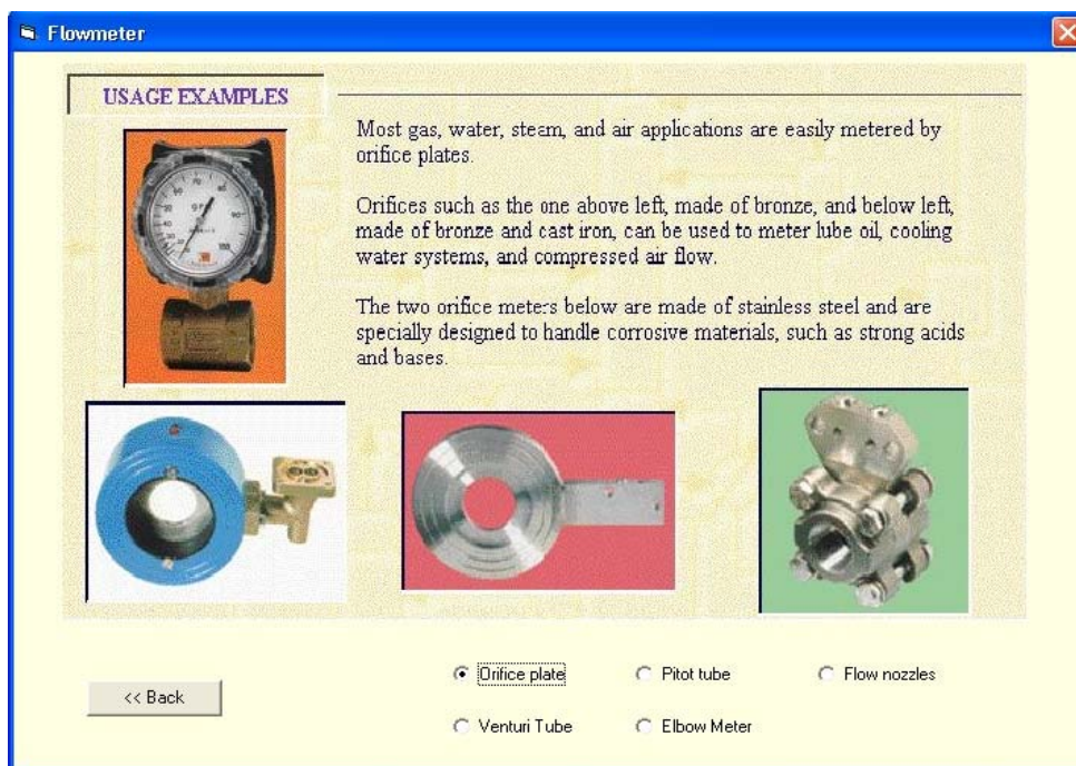
شکل ۸۵.۳: انواع دبی‌سنج‌های از نوع Differential Pressure
