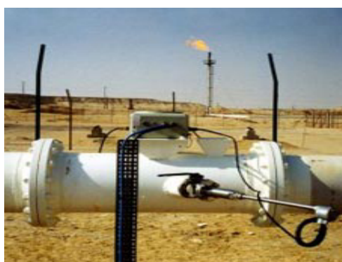
شکل ۲۶.۳: دبی‌سنج آلتراسونیک FlareSonic شرکت الستر
