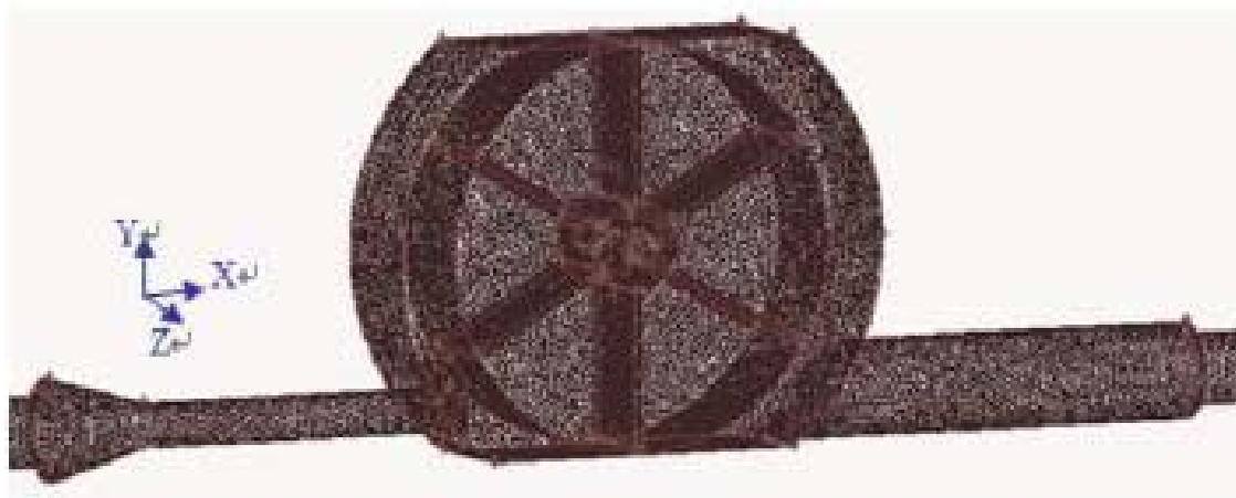
شکل ۹.۸: مدل مش‌بندی شده دبی‌سنج توربینی مماسی
